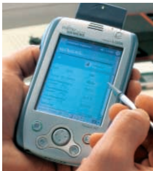
Praktische, ortsunabhängige Fernbedienung der UNIGYR®-Anlagen über Pocket PC.
